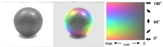
図 9 ボールの偏光イメージング像。左のボールの撮影データから偏光方向の情報を計算し、カラーマップに従い表示させた結果。
