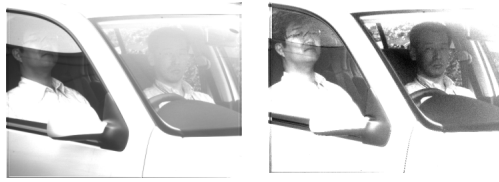
図 8 偏光イメージングにより車の窓ガラスの映り込みを除去した結果。左が未処理の画像で、右が偏光成分を除去した画像。フロント、サイドともに映り込みが効果的に除去できている。
