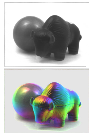
図 10 二つの物体の偏光イメージング像。偏光情報を加えることで二つの物体の境界が明確になる。
